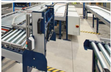
Se ha instalado un transportador abatible que facilita el paso de los operarios.
