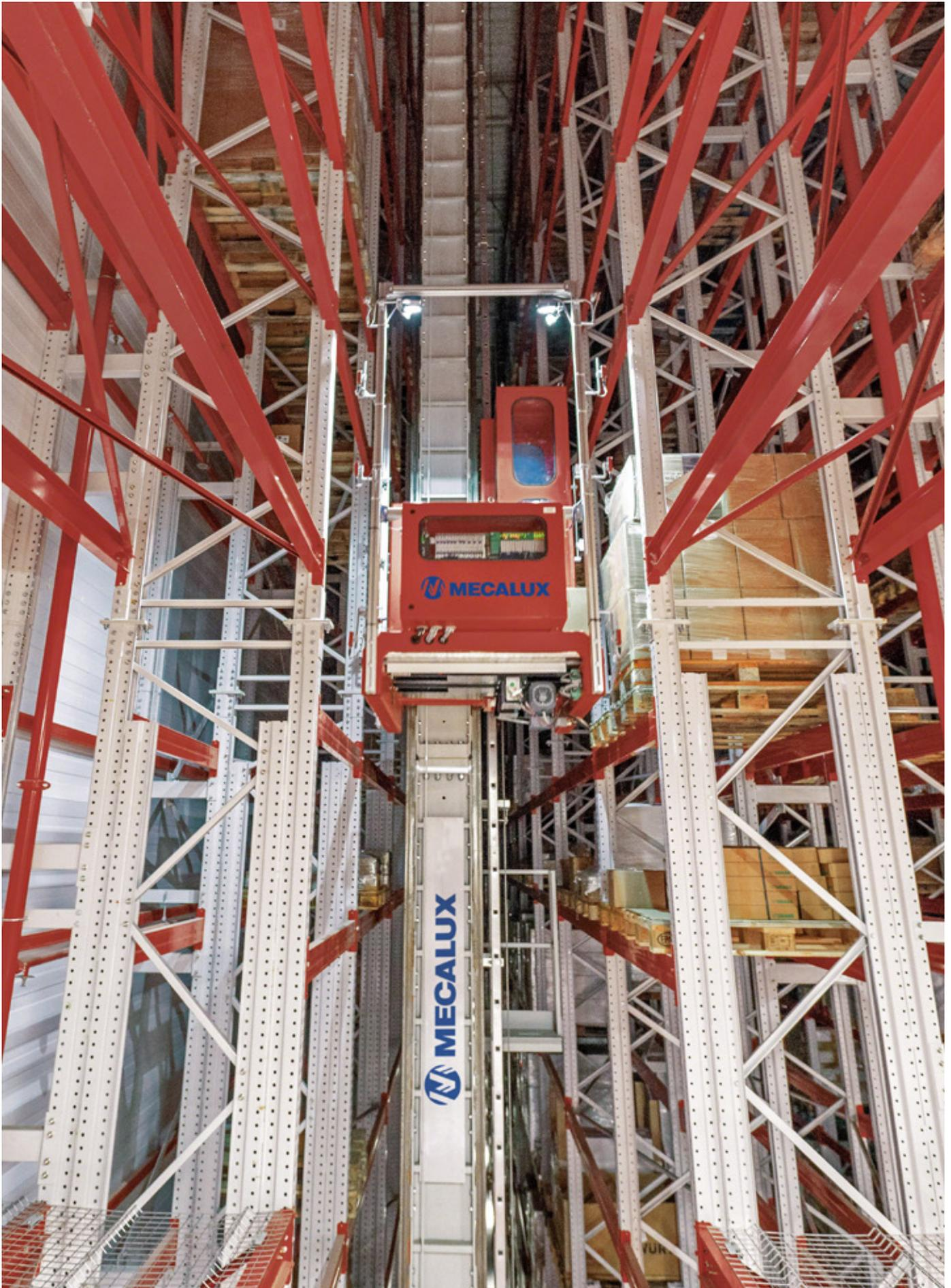
Transelevador monocolumna de simple profundidad con una velocidad de traslación de 220 m/min y 54 m/min en elevación.
