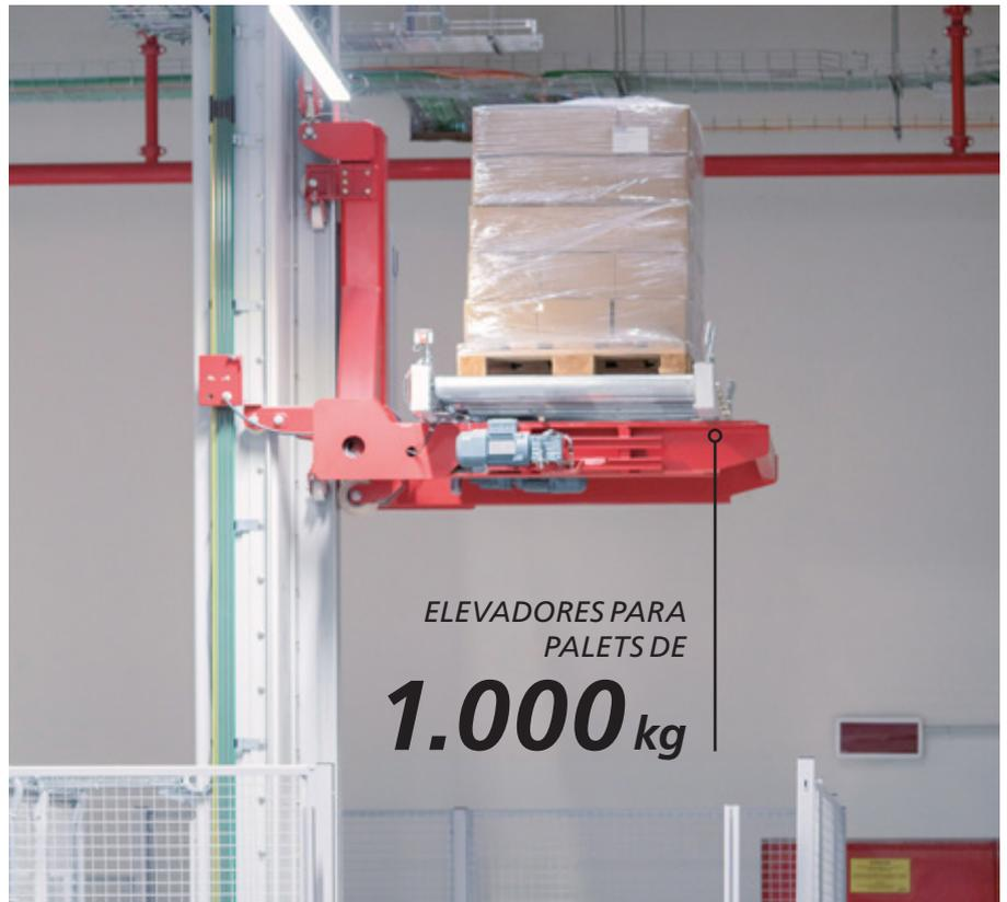
**La instalación incluye dos elevadores.** Uno comunica la zona de recepción y expedición (planta inferior) con las entradas y salidas del almacén automático (planta su-
