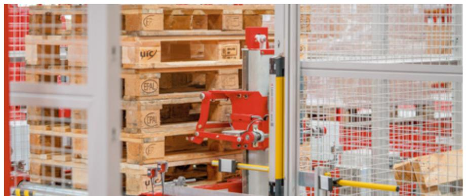
El sistema suministra palets vacíos para ser utilizados como palets esclavos y, de ese modo, remontar aquellos que el puesto de inspección detecta como defectuosos.
