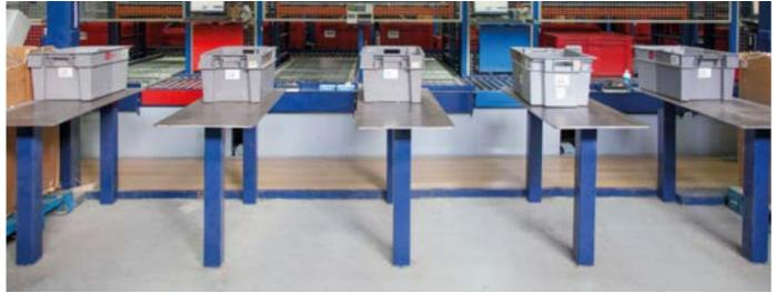
La cabecera del almacén automático de Unidroco cuenta con cuatro puestos de picking equipados con dispositivos 'put-to-light'
