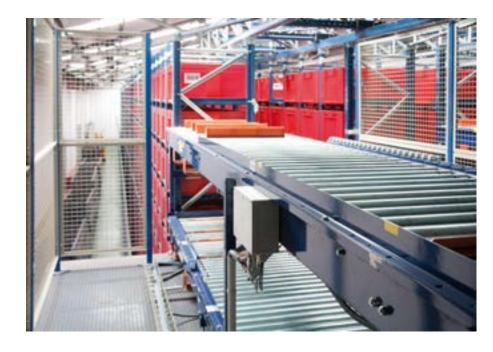
Mecalux ha suministrado un almacén automático miniload con capacidad para más de 14.200 cajas y una cabecera de dos niveles: la parte inferior para el picking y la parte superior para la reposición
