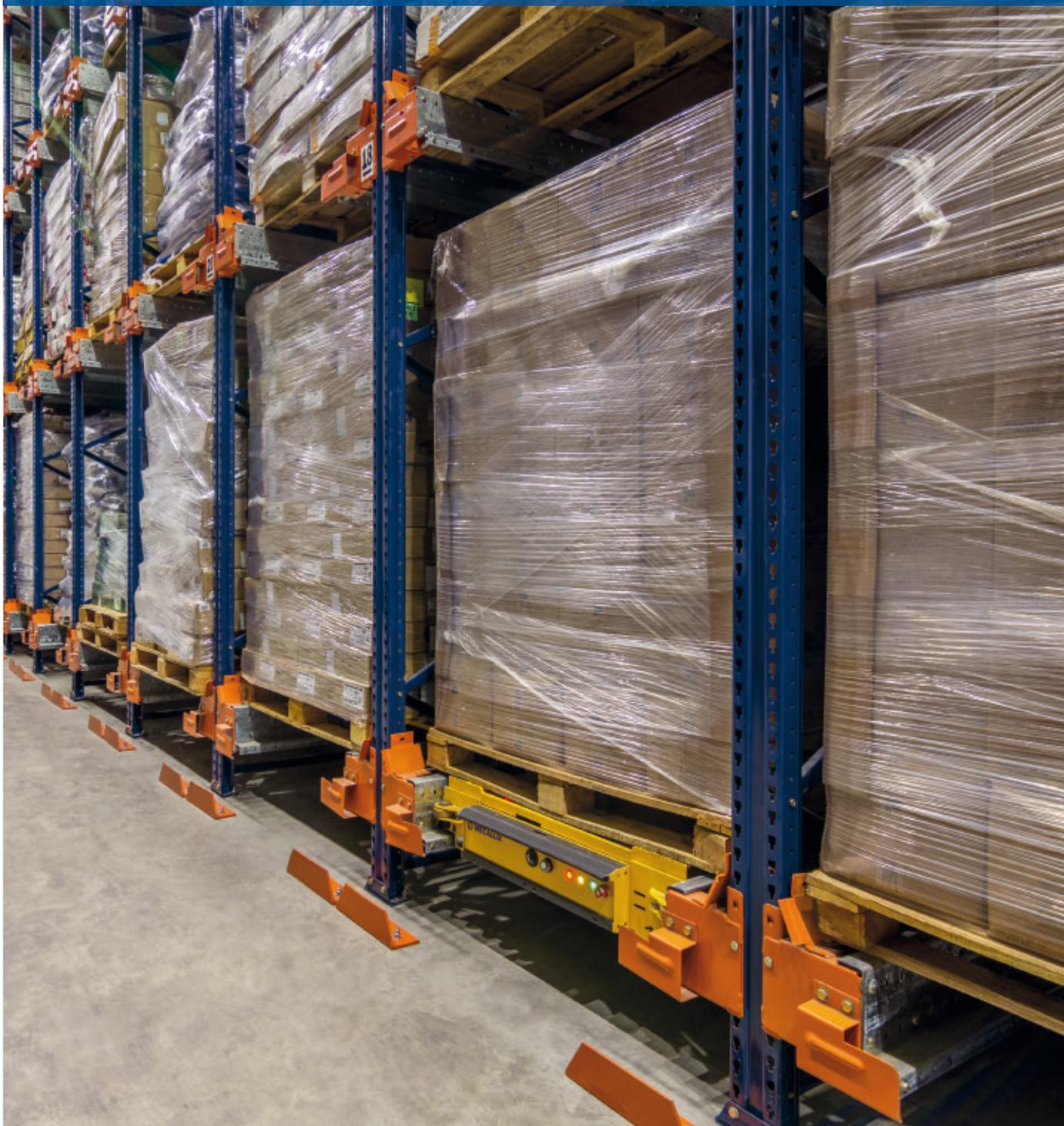
El operador logístico argentino Frío Dock ha estrenado un nuevo almacén en Tortuguitas (Buenos Aires) con el que afrontar el incremento de la producción de sus clientes. Mecalux lo ha equipado con dos bloques de estanterías con el sistema Pallet Shuttle semiautomático que proporcionan una capacidad de almacenaje para 2.280 palets.
