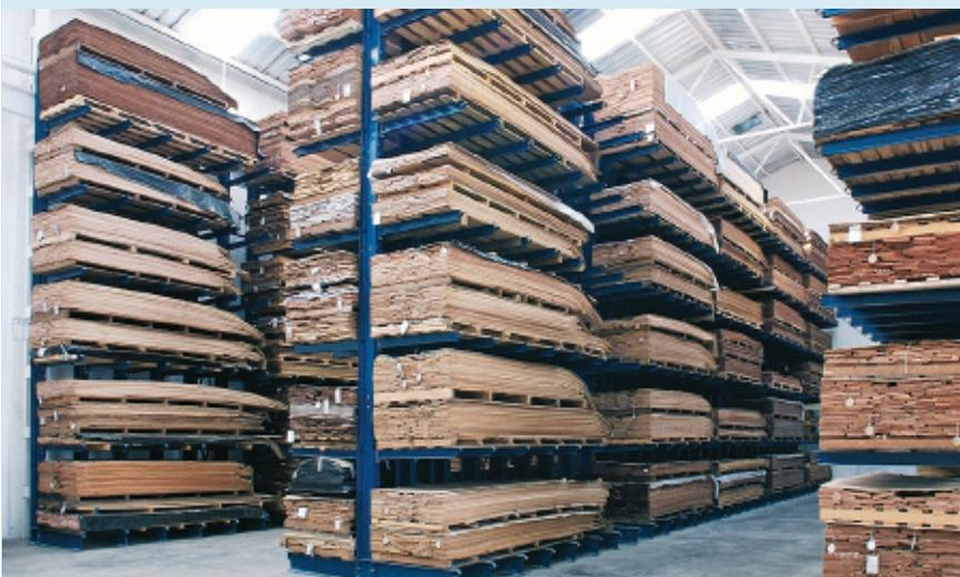
Están formadas básicamente por perfiles verticales (columnas) y perfiles horizontales (bases), que se colocan como soporte para aportar estabilidad, así como por brazos en voladizo sobre los que se deposita la carga.
