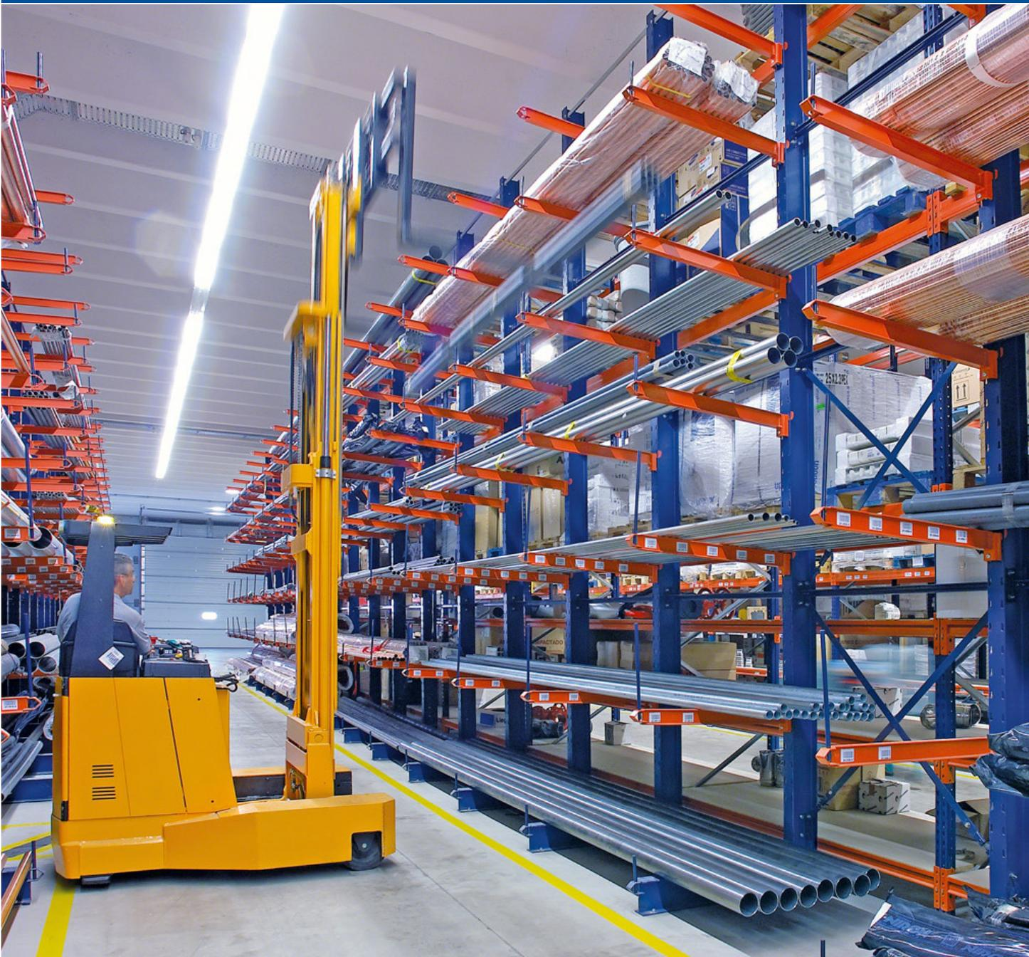
Mecalux ha desarrollado distintos perfiles metálicos laminados en caliente para conformar el sistema de estanterías cantilever, con grosores y medidas que abarcan todas las exigencias del mercado: columnas y brazos para cargas ligeras, medias o pesadas. Para elegir el sistema más adecuado, además del peso de la carga, deben considerarse también
