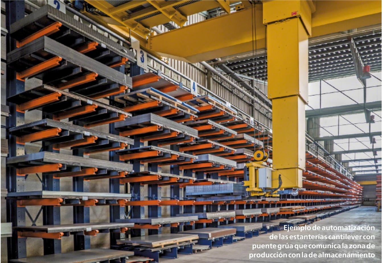
Ejemplo de automatización de las estanterías cantilever con puente grúa que comunica la zona de producción con la de almacenamiento
