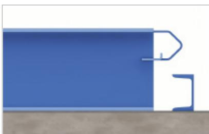
Detalle del perfil utilizado para las guías
