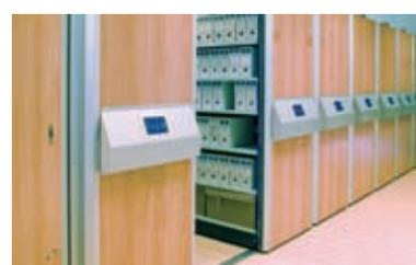
**Accionamiento eléctrico.** Al pulsar un conmutador de maniobra, el conjunto de armarios se desliza en bloque automáticamente dejando abierto el pasillo elegido. El sistema de tracción consiste en un motor acoplado a los conjuntos reductores y de transmisión de las bases. Dispone de un sistema de seguridad para evitar el desplazamiento de los armarios mientras se trabaja en el interior del pasillo.
