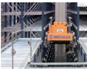
**Elementos de cabecera (zona de picking).** Ubicados en la parte frontal o lateral de las estanterías, realizan los movimientos mecánicos para acercar las cajas al operario, o bien al transelevador, a fin de que éste las recoja y las vuelva a ubicar en el almacén. Formados por una serie de transportadores, que favorecen la comunicación entre los puestos de trabajo y el transelevador, agilizan las entradas y salidas del sistema.
