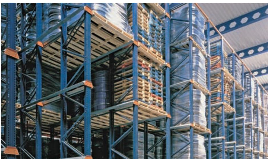
Este sistema de almacenaje está compuesto por un conjunto de estanterías, que forman calles interiores de carga, con carriles de apoyo para las paletas. Las carretillas penetran en dichas calles interiores con la carga elevada por encima del nivel en el que va a ser depositada.
