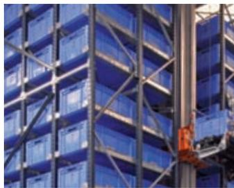
**Las estanterías.** Diseñadas para adaptarse perfectamente al movimiento del transelevador y pensadas para el almacenaje de cajas en altura. Su diseño permite un mayor aprovechamiento del espacio y un aumento de la capacidad de almacenaje, optimizando los movimientos del robot.
