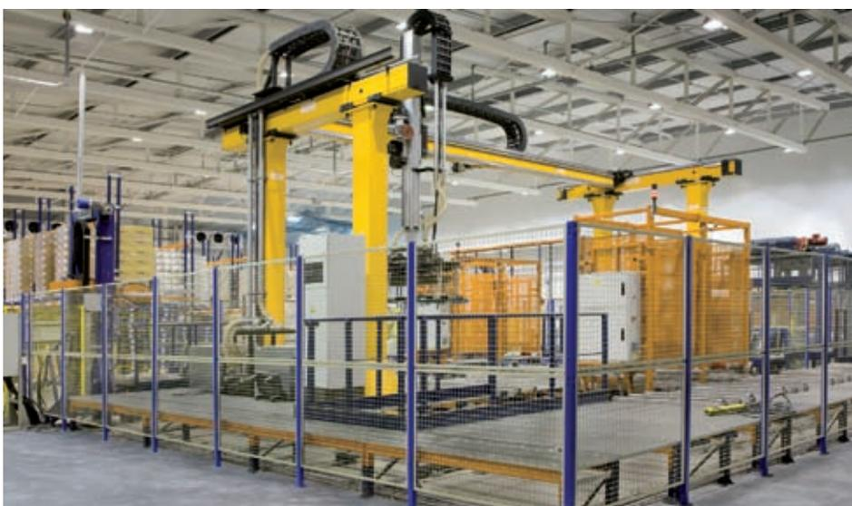
Los cierres de seguridad crean un espacio protegido en el área de trabajo de instalaciones automáticas y robots de fabricación. Asimismo, preservan la zona de posibles materiales desprendidos por la acción de las máquinas.
