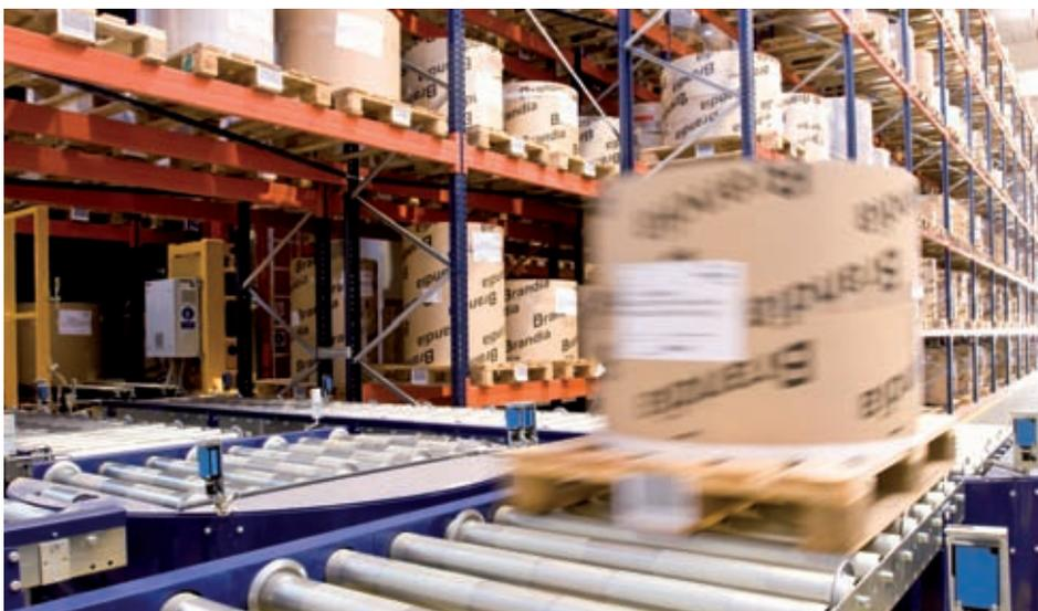
Los transelevadores son máquinas creadas para el almacenamiento automático de materiales mediante movimientos mecánicos automatizados. Las entradas y salidas de la carga se ejecutan en un mismo movimiento (ciclo combinado). Esto incrementa la productividad de las instalaciones al mismo tiempo que disminuye los recursos requeridos para su funcionamiento.
