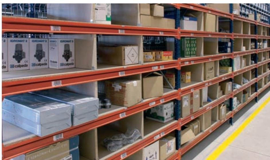
Diseñadas para aquellos almacenes donde la mercancía se deposita y retira manualmente. Este sistema aprovecha toda la altura del almacén, ya que se puede acceder a los niveles altos tanto por medios mecánicos, que elevan al operario hasta la altura deseada (traselevadores o carretillas recoge-pedidos), como mediante pasarelas colocadas entre las estanterías.
