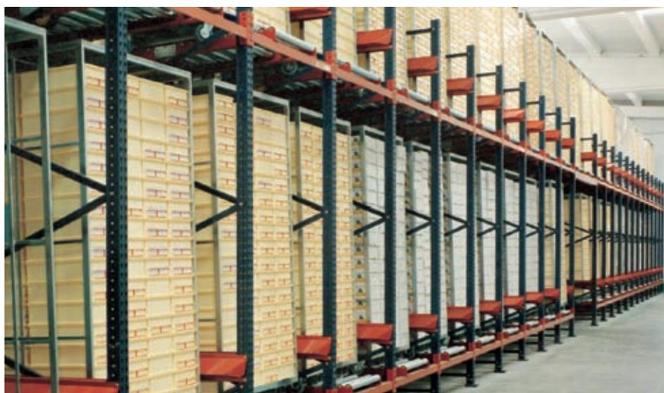
Las estanterías para paletización dinámica por gravedad incorporan caminos de rodillos con una ligera pendiente, lo que permite el deslizamiento de las paletas.
