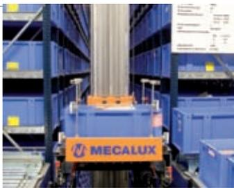
**Transelevador.** Es el robot encargado de realizar las operaciones de ubicación y de extracción de las cajas en las estanterías, así como de transportarlas y depositarlas en la mesa de cabecera del almacén. Tiene dos movimientos: longitudinal sobre el rail, a lo largo del pasillo, y vertical, para ubicar las cajas en los distintos niveles de las estanterías.
