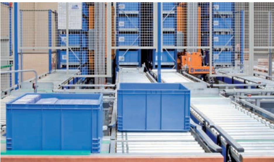
Los almacenes miniload se basan en el principio "producto a hombre": las unidades de carga (cajas), situadas en las estanterías, son manipuladas automáticamente por un transelevador, que las acerca al puesto del operario para que éste extraiga o deposite el producto. A continuación, las cajas son devueltas a su lugar en la estantería por el mismo procedimiento.
