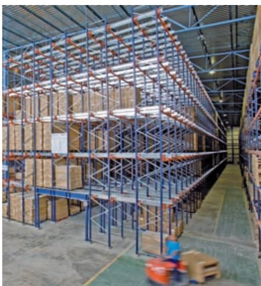
Es un sistema de almacenaje para paletas de alta densidad que facilita la carga y descarga de mercancía a partir de un carro eléctrico denominado Radio-Shuttle.
