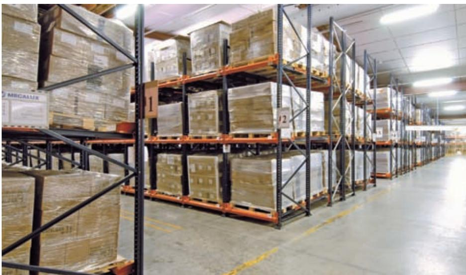
Sistema de almacenaje por acumulación que permite almacenar hasta cuatro paletas en profundidad por cada nivel. Todas las paletas de un mismo nivel, a excepción de la última, se asientan sobre un conjunto de carros que se desplazan, por empuje, sobre los carriles de rodadura. Las paletas depositadas se gestionan por el principio LIFO (la última que entra es la primera que sale).
