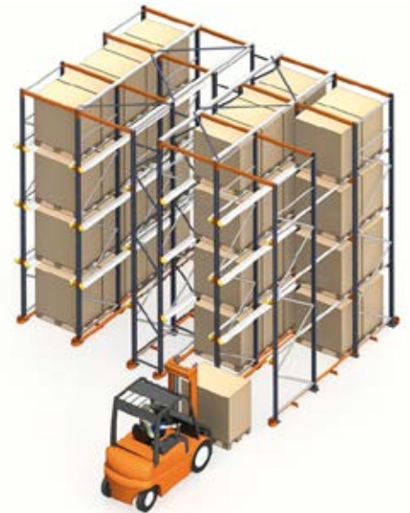
Estabilidad de las estanterías en el sistema constructivo 2 con acceso único o doble
