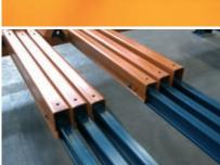
La forma en I del carril permite que los elementos de rodadura estén enhebrados a ambos lados del alma, garantizando un correcto desplazamiento y evitando la posibilidad de descarrilamiento.
