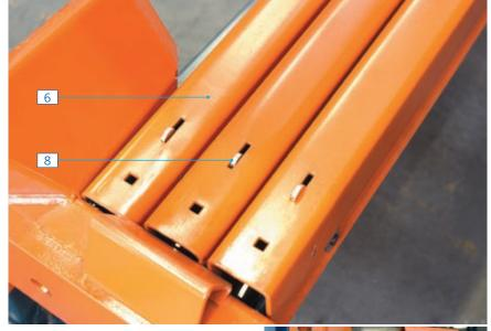
Cada carro, además de los elementos de rodadura, dispone de un gatillo de seguridad que impide su desplazamiento si la paleta no ha sido correctamente apoyada.
