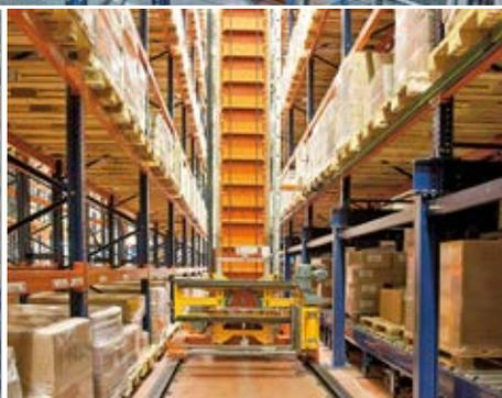
Sistema integrado de extracción trilateral gracias a un cabezal giratorio que recoge y deposita las paletas en tres posiciones.
