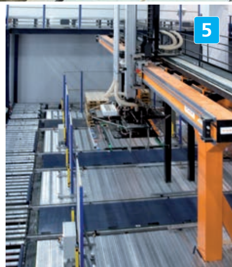
El robot de picking automático permite preparar pedidos de los productos de alta rotación por mantos. Las paletas son alimentadas mediante los transelevadores y los transportadores de la cámara automática.
