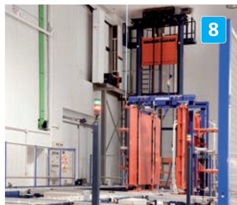
Los transportadores de rodillos o cadenas, el puesto de control automático, la compactadora, los elevadores y los elementos de seguridad y control garantizan un transporte automático, seguro y de alta capacidad.
