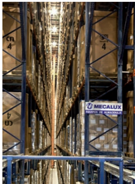
Pasillo de almacenaje con transelevador.
