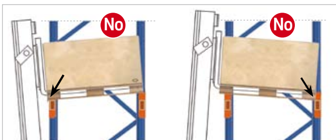
Figura 9 Sobrecarga sobre un larguero por descenso no horizontal
