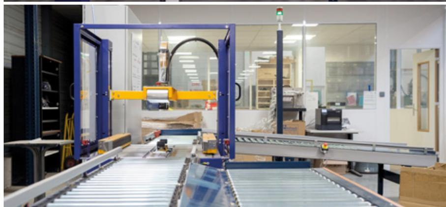
En paralelo, se encuentra un transportador con rodillos no accionados para que los operarios desplacen las cajas manualmente hasta la posición más cómoda.
