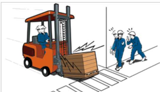
Figura 4 Moderación de la velocidad en intersecciones
