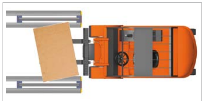
No circular con la paleta girada en el interior de las estanterías
