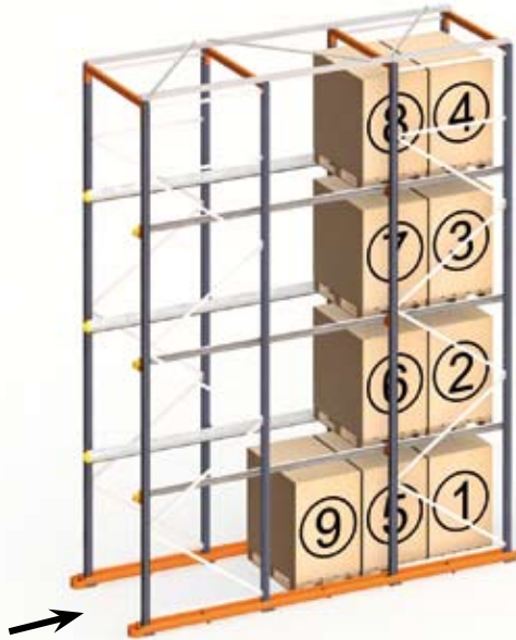
Secuencia de entrada de carga
