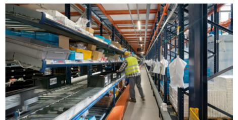
El bloque de picking se compone de estanterías dinámicas para palets y cajas, estanterías con estantes y un circuito de transportadores que forma dos áreas de preparación de pedidos en cada planta
