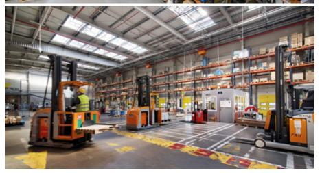
Para hacer picking en los niveles inferiores de las estanterías, los operarios trabajan con máquinas preparadoras de pedidos de cota baja y con elevación.
