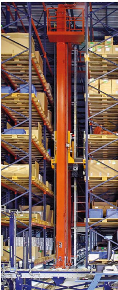
Los transelevadores son máquinas creadas para el almacenamiento automático de materiales mediante movimientos mecánicos automatizados. Las entradas y salidas del material se ejecutan en un mismo movimiento (ciclo combinado). Esto incrementa la productividad de las instalaciones al mismo tiempo que disminuye los recursos requeridos para su funcionamiento.
