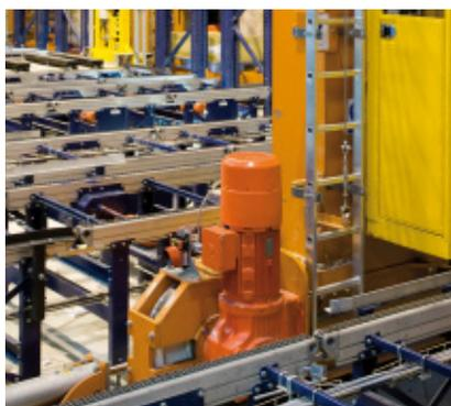
Con el objeto de asegurar un funcionamiento seguro y silencioso del transelevador, tanto la rueda motriz como la rueda libre han sido diseñadas con llanta plana mecanizada y en acero fundido. La superficie de rodadura ha sido tratada especialmente.
